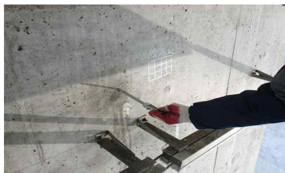
교각 탄산화 시험
